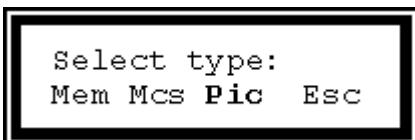
Первые три кнопки соответственно выбирают стандартные микросхемы памяти, однокристалки MCS-51 или PIC контроллеры. Эти же клавиши при нажатой четвертой кнопке 'Menu' выбирают AVR, Serial EEPROM или Favorites - список, сформированный пользователем.
