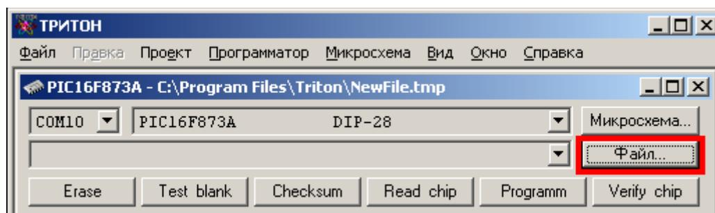
Откроется стандартный диалог выбора файла. Можно посмотреть все файлы в папке или отфильтровать список по типам. Файлы в шестнадцатиричных форматах (Intel, Motorola, Tektronix...), при открытии автоматически преобразуются в двоичные. Если расширение файла не совпадает с зарегистрированными расширениями или его формат не соответствует спецификации, то файл будет открыт как двоичный.
