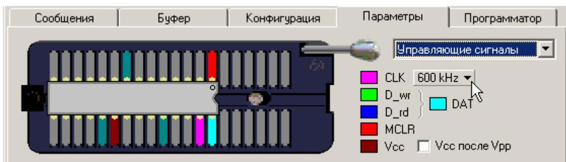
Правильно установите микросхему в панельку программатора и нажмите кнопку "**PROGRAMM**". Если установлен флаг "[Подтверждать операции записи и стирания](#)", то программа выведет запрос о начале цикла записи. Если микросхема имеет режим стирания, EEPROM или другие дополнительные области, которые нужно записать, то можно разрешить к ним доступ, непосредственно из этого окна. Флаги режимов работы в этом окне имеют более высокий приоритет, чем одноименные флаги в окне проекта.
