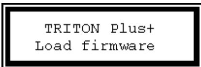
**Восстановления прошивки.** Включение питания с нажатыми кнопками 'Menu' и 'Vr.' - переводят программатор в режим [восстановления прошивки](#). Этот режим может потребоваться после неудачного обновления прошивки, когда программатор не реагирует на запросы компьютера.
