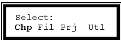
В начале необходимо выбрать микросхему. Для этого кратковременно нажмите кнопку 'Menu', затем кнопку 'Chp' - выбор микросхемы. Программатор предложит выбрать группу микросхем. В программаторе для ускорения поиска все микросхемы сгруппированы в шесть групп по типам (Memory, MCS-51, PIC, AVR, Serial EEPROM и Favorites). При этом возможна прокрутка всего списка.
