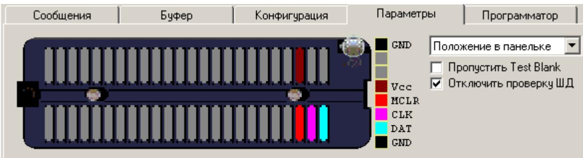
Как и для переходника TSH-ICSP программа позволяет изменять конфигурацию выводов на разъеме ISP-CONN. Для этого в положениях "Начальное состояние" и "Управляющие сигналы" надо мышкой перетащить сигналы на требуемые выводы. Сигналы перетаскиваются только на панельке программатора и отображаются на разъеме.
