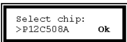
После выбора нужной группы, производится поиск микросхемы в списке. Левая кнопка - отмена режима и выход, две средние - прокрутка списка (для этих клавиш работает автоповтор), правая - выбор микросхемы.
